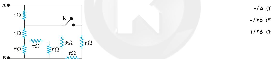
۱۴۴ - شکل زیر، قسمتی از یک مدار الکتریکی را نشان می‌دهد. بزرگی جریان در نقطه M بر حسب آمپر و جهت آن به ترتیب از راست به چپ کدام است؟
