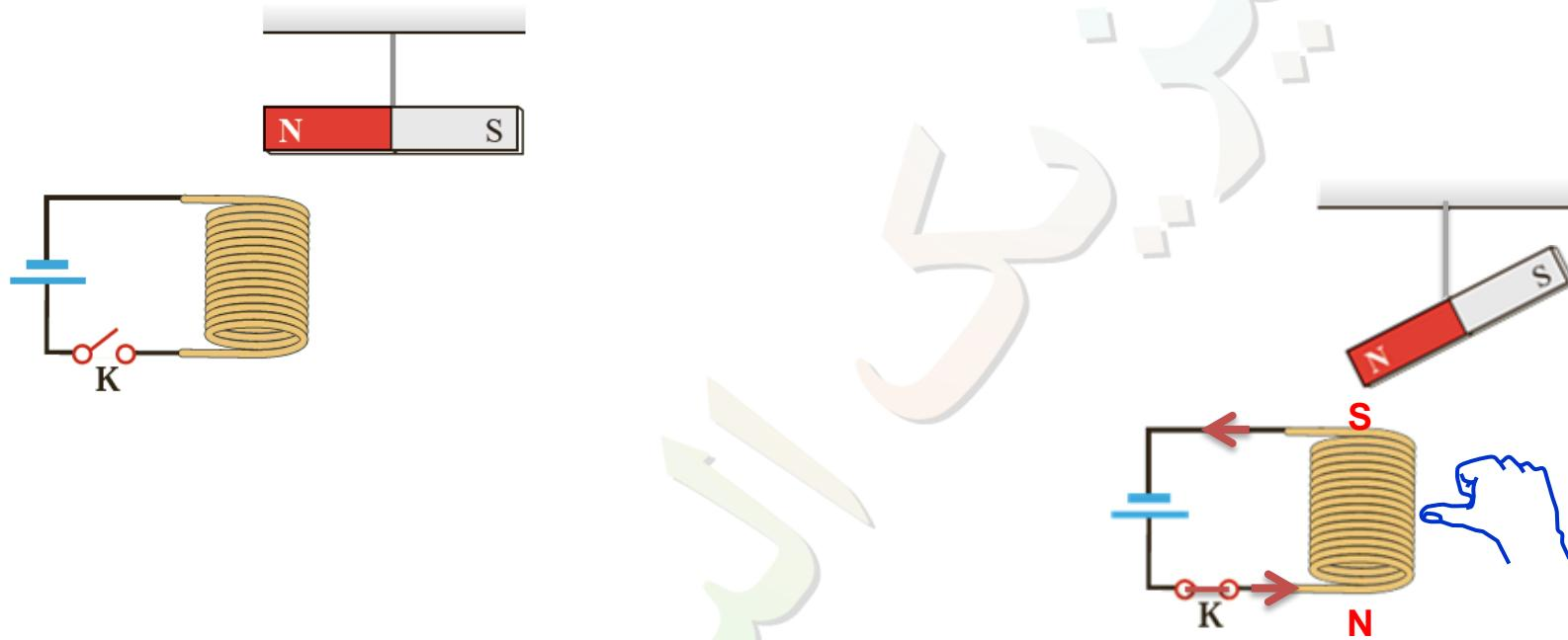
با وصل کلید جریان ایجاد شده در سیم‌وله به سمت چپ بوده و با توجه به قانون دست راست قطب‌های ناهمنام سیم‌وله مجاور قطب‌های آهنربای میله ای قرار می‌گیرد، که در این وضعیت قطب N آهنربای میله ای به سمت پایین کشیده می‌شود
