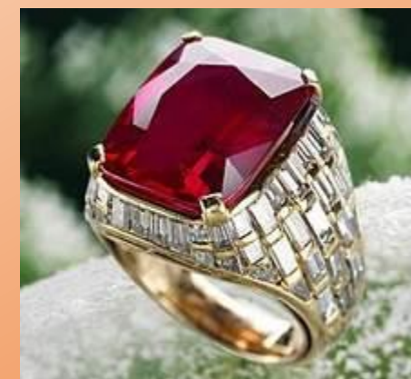
یاقوت ( یونهاى Cr^{3+} جانشین یونهاى Al^{3+} در اکسید آلومینیوم شده‌اند
