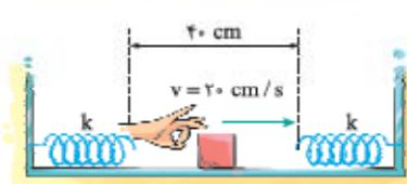
۵۵۷- در شکل روبرو، ثابت هر فنر  $N / m$  و اصطکاک در سطح افقی ناچیز است. وقتی هر دو فنر طول عادی خود را دارند، فاصله انتهای آزاد آن‌ها از یکدیگر  $40 \text{ cm}$  است. وزنه کوچکی به جرم  $100 \text{ g}$  را بین فنرها قرار داده و به آن سرعت اولیه  $20 \text{ cm} / \text{s}$  می‌دهیم. این وزنه بین دو فنر حرکت نوسانی پیدا می‌کند. دوره تناوب این حرکت چند ثانیه است؟ ( $\pi = ۳$ ) (۷)
