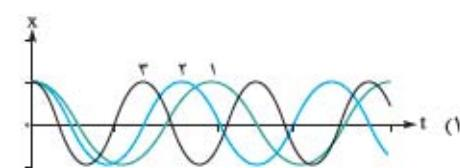
۵۴۵- سه سامانه جرم- فنر با جرم های مشابه داریم که با شماره های ۱، ۲ و ۳ مشخص شده اند. این سه سامانه، به نوسان در آمده اند و یک نوسان نگار، نمودار مکان- زمان آن ها را ثابت می کند. اگر ارتباط ثابت فنرهای سه سامانه، به صورت  $k_1 < k_2 < k_3$  باشد، گدام گزینه، نمودارهای ثبت شده را درست نشان می دهد؟
