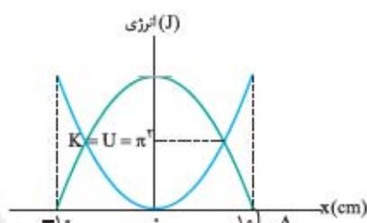
**نمودارهای انرژی جنبشی و پتانسیل یک سامانه جرم - فنر بر حسب مکان وزنه به شکل رویه رو است. ثابت فنر چند نیوتن بر متر بوده است؟**
