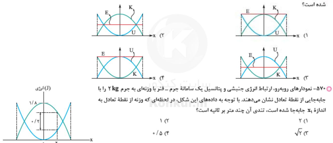
۵۷۰- نمودارهای رویه‌رو، ارتباط انرژی جنبشی و پتانسیل یک سامانه جرم - فنر با وزنه‌ای به جرم  $2\text{ kg}$  را با جایه‌جایی از نقطه تعادل نشان می‌دهند. با توجه به داده‌های این شکل، در لحظه‌ای که وزنه از نقطه تعادل به اندازه  $\frac{1}{2}$  جایه‌جا شده است، تندی آن چند متر بر ثانیه است؟
