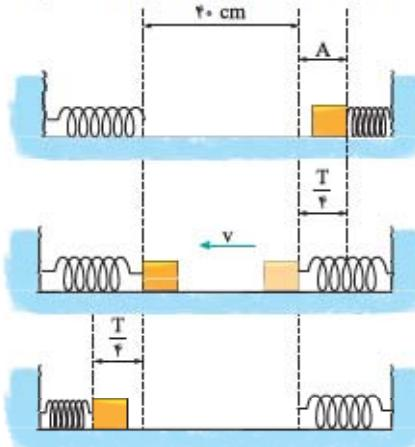
باید حرکت وزنه را از لحظه‌ای مورد بررسی قرار دهیم که همانند شکل رویه‌رو (اولین شکل)، فنر سمت راست، بیشترین فشردگی را دارد. برای رسیدن به وضع تعادل، این وزنه به زمان  $\frac{T}{4}$  نیاز دارد:
