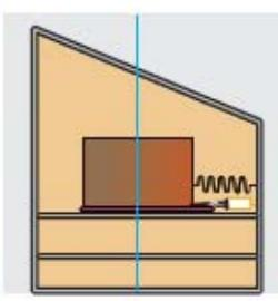
۵۵۲- یک سامانه غولپیکر جرم - فنر، با وزنهای به جرم  $4 \times 10^5\text{ kg}$ ، در بالای یک برج طبقه در نیویورک قرار داده شده است. این سامانه، نوسان‌هایی هم‌بسامد با برج و در خلاف جهت آن انجام می‌دهد تا سبب کاهش نوسان کلی برج شود. اگر دوره تعادل این سامانه،  $6.5\text{ s}$  باشد و هنگام وزش یک باد شدید، روی مسیری به طول،  $220\text{ cm}$ ، ثابت فنر و تندی بیشینه وزنه (در SI)، به ترتیب از راست به چپ، کدام است؟ ( $\pi = 3$ )
