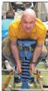
۵۴۸- برای اندازه‌گیری جرم فضانوردان در ایستگاه‌های فضایی، از یک صندلی متصل به فنر استفاده می‌شود. فضانورد بر روی این صندلی قرار می‌گیرد و صندلی به نوسان درمی‌آید. در یک ایستگاه فضایی، ثابت فنر متصل به این صندلی  $600\text{ N/m}$  و دوره تعادل نوسان صندلی خالی  $9/5$  است. وقتی فضانوردی روی این صندلی قرار می‌گیرد، دوره تعادل نوسان آن  $2/55$  می‌شود. جرم فضانورد چند کیلوگرم است؟ ( $\pi^2 = 10$ )
