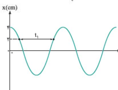
۵۱۴- نمودار مکان – زمان حرکت هماهنگ ساده‌ای به صورت شکل مقابل است. اگر بسامد نوسانگر  $t$  هر تیز باشد،  $t$  چند ثانیه است؟
