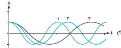
۵۴۶- گلوله ای همانند شکل رویه رو، روی یک سطح افقی بدون اصطکاک به یک فنر افقی متصل است و ابتدا در نقطه تعادل قرار دارد. این گلوله را از نقطه تعادل، یک بار به اندازه ۵ cm و بار دوم، به اندازه ۱۰ cm به سمت می گشیم و رها می کنیم. در گدام گزینه، نمودار مکان- زمان حرکت دو گلوله، درست رسم شده است؟
