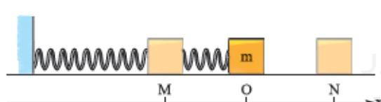
شکل رویه‌رو، یک سامانه جرم – فنر را نشان می‌دهد که بر سطح افقی بدون اصطکاکی نوسان می‌کند. اگر نوسانگر در مدت ۵ از نقطه O (نقطه تعادل)، به نقطه M (یک انتهای مسیر) رسیده باشد و در این مدت، جهت حرکتش یک مرتبه تغییر کرده باشد، دوره تناوب آن چند ثانیه بوده است؟
