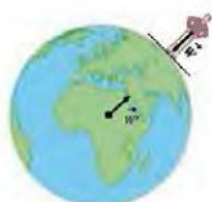
شکل الف-۱: نیروی وزن بر جسم گرانشی (W) وارد می کند و جسم نیز بر زمین نیروی گرانشی (W') وارد می کند.
