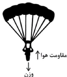
$$W_t = K_2 - K_1 \Rightarrow W_{\text{وزن}} + W_{\text{مقاومت هوا}} = \frac{1}{2}mv_2^2 - \frac{1}{2}mv_1^2$$
