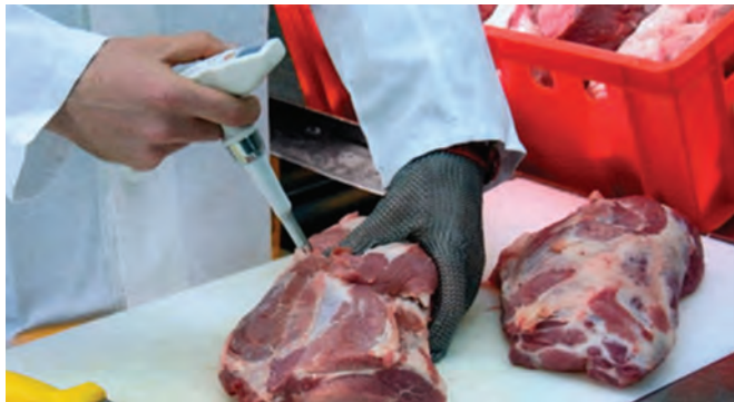
شکل ۲۲- به کارگیری pH سنج برای اندازه‌گیری pH مواد غذایی
