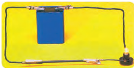
شکل ۳۵- مدار بررسی‌کننده هدایت الکتریکی مواد
