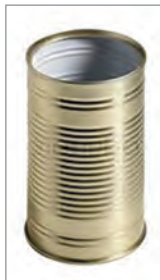
شکل ۴۳- قوطی‌هایی از جنس حلبی در اثر خراش زودتر و آسان‌تر دچار خوردگی می‌شوند.
