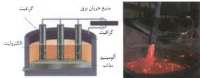
شکل ۱۸- فرایند هال برای تولید آلومینیوم از \text{Al}_2\text{O}_3
