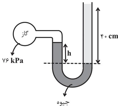
چگالی  $\rho_{\text{Hg}} = 13/6 \frac{\text{g}}{\text{cm}^3}$  و مایعی با چگالی  $\rho_L = 1230 \frac{\text{kg}}{\text{m}^3}$  در حال تعادل وجود دارد. اگر
