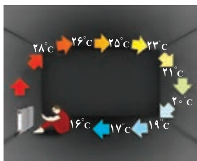
شکل ۴-۲۸ گرم شدن هوای اتاق به روش همرفت
