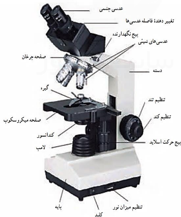
بخش های اصلی یک میکروسکوپ نوری
