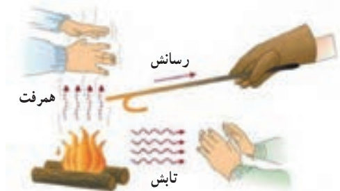
شکل ۴-۲۷ هر سه روش انتقال گرما را در این تصویر مشاهده می‌کنید.
