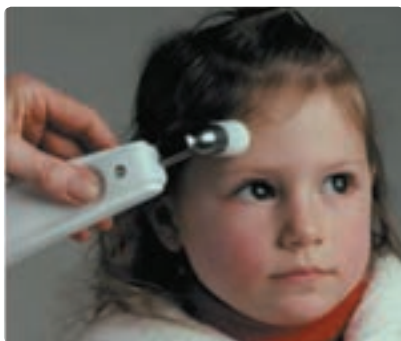
(ب) دماسنج تابشی که بر اساس آشکارسازی شدت تابش گرمایی خروجی از پوست کار می‌کند.
