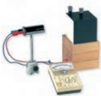
شکل ۴-۳۸ درون مکعب لسلی، آب داغ می‌ریزند. تابش گرمایی از چهار وجه مکعب، که رنگ‌های متفاوتی دارند، با هم فرق دارد.
