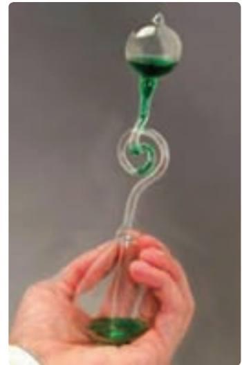
شکل ۴-۴۳ با در دست گرفتن حباب شیشه‌ای و گرم کردن آن، مایع رنگی در لوله مارپیچ بالا می‌رود.
