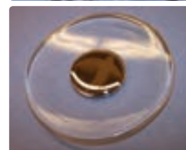
شکل ۳-۱۱ (الف) پخش آب روی سطح شیشه (ب) قطره‌ای شدن جیوه روی سطح شیشه
