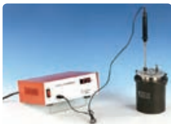
شکل ۷-۴ در این تصویر دمای یک گرماسنج به روش الکتریکی اندازه‌گیری می‌شود.
