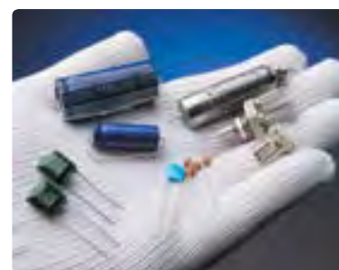
شکل ۱-۳۶ تصویری از چند خازن مختلف
