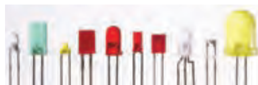
شکل ۲-۲۵ تصویری از چند دیود نورگسیل
