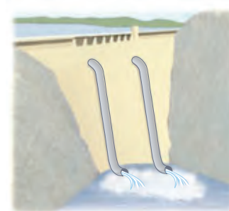
شکل ۲-۴۱ مقاومت الکتریکی معادل دو مقاومت یکسان را می‌توان با دو لوله آب یکسان که از آنها جریان‌های آبی مطابق شکل می‌گذرد، مشابهت‌سازی کرد.
