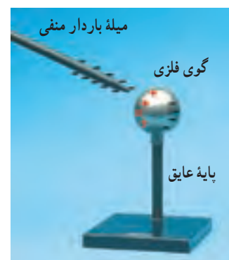
شکل ۳۰-۱ نزدیک کردن میله باردار منفی به گوی فلزی خنثایی که روی پایه عایقی قرار گرفته است، موجب ایجاد بارهای القایی مثبت و منفی در دو طرف گوی فلزی می‌شود.
