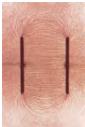
شکل ۱۹-۱ سمت گیری دانه‌ها در فضای بین دو الکترود صفحه‌ای موازی
