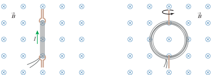
شکل ۳-۴ با چرخاندن پیچه درون میدان مغناطیسی \vec{B} ، زاویه بین میدان مغناطیسی و سطح پیچه تغییر می‌کند. این تغییر زاویه سبب القای جریان در پیچه می‌شود.
