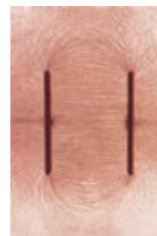
شکل ۱۹-۱ سمت‌گیری دانه‌ها در فضای بین دو الکترودهای موازی
