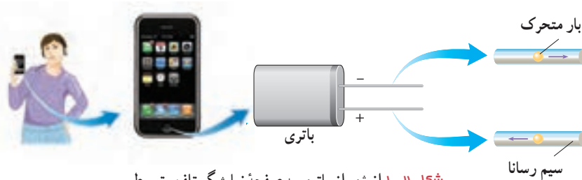
شکل ۲-۱ انرژی از باتری به صفحه نمایشگر تلفن، توسط بارهایی که از سیم‌های رسانا می‌گذرند، منتقل می‌شود.
