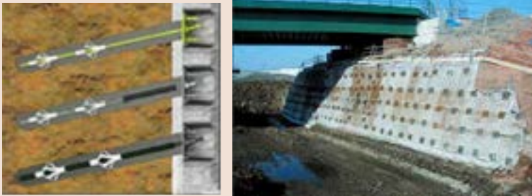
پایدارسازی شیب به روش میخ کوبی
