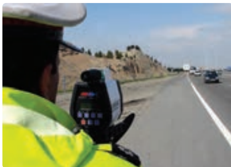
شکل ۳۰-۳۰ تعیین تندی خودروها به کمک اثر دوپلر
