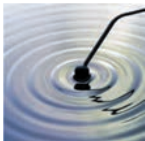
شکل ۱۶-۳ تشکیل امواج دایره‌ای بر سطح آب یک تشت موج
