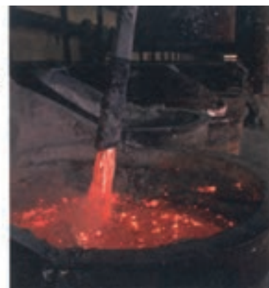
شکل ۱۸- فرایند هال برای تولید آلومینیم از \text{Al}_2\text{O}_3
