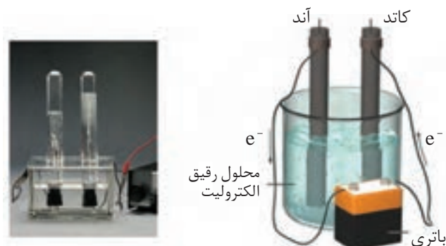
شکل ۱۱- تجزیه آب به عنصرهای سازنده آن با مصرف انرژی الکتریکی
