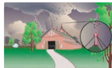
شکل ۳-۷- برق‌گیر، ساختمان را از خطر برخورد آذرخش حفظ می‌کند.
