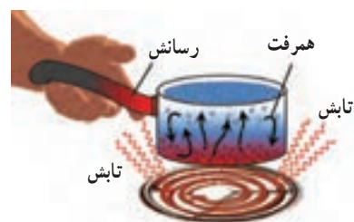
شکل ۶-۹- در این شکل، هر سه روش انتقال گرما را در تصویری مشاهده می‌کنید.
