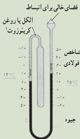
شکل ۳-۶- طرح واره ای از یک دماسنج بیشینه - کمینه و شکلی واقعی از یکی از انواع آن
