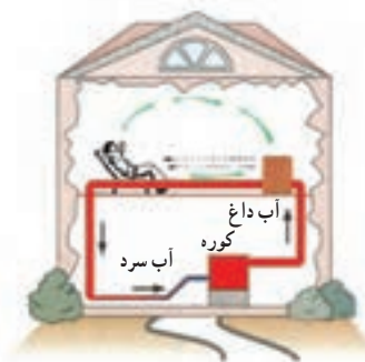
شکل ۶-۱۴- گرم شدن هوای اتاق به روش همرفت
