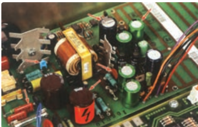
شکل ۲-۲۴ مدار یک تقویت‌کننده که شامل چند خازن است. برخی از خازن‌ها با پیکان مشخص شده‌اند.
