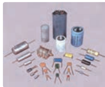
شکل ۲-۲۱ تصویری از چند خازن مختلف
