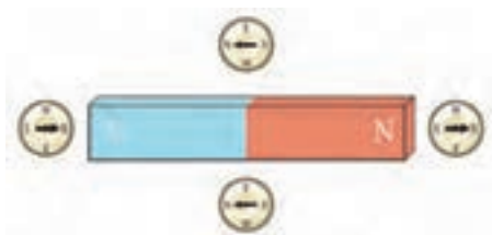
شکل ۴-۸ تعیین جهت میدان مغناطیسی به کمک عقربه مغناطیسی
