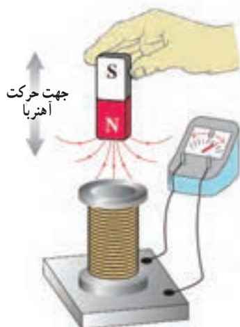
شکل ۱-۵ با حرکت آهنربا به طرف سیملوله یا پیچه گالوانومتر جریان القایی را نشان می‌دهد.
