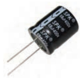
شکل ۳۱-۲ تصویری از یک خازن که روی آن ظرفیت و اختلاف پتانسیل قابل تحمل بیشینه نوشته شده است.
