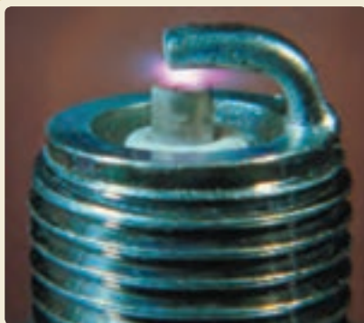
انرژی لازم برای جرقه زدن شمع اتومبیل، از انرژی مغناطیسی ذخیره شده در پیچه احتراق تأمین می‌شود.
