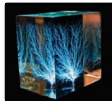
شکل ۳۰-۲ فروریزش الکتریکی باعث تشکیل مسیرهای رسانایی سرخس‌شکلی در دی‌الکتریک شده است.
