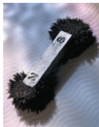
شکل ۳-۴ در یک آهنربا، به هر شکلی که باشد، دو ناحیه وجود دارد که خاصیت مغناطیسی در آنها بیش از قسمت های دیگر است.
