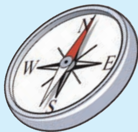
عقربه قطب‌نما آهنربای کوچکی است که می‌تواند آزادانه دور محور خود بچرخد.
