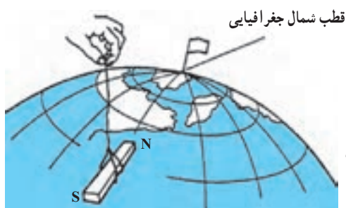
شکل ۴-۴ آهنربا در این وضعیت مانند یک قطب نما رفتار می کند.
