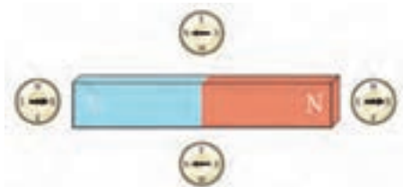
شکل ۸-۳ تعیین جهت میدان مغناطیسی به کمک عقربه مغناطیسی
