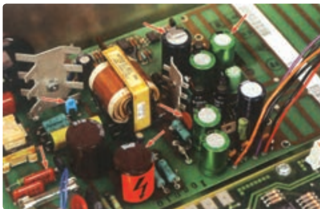
شکل ۱-۲۴ مدار یک تقویت کننده که شامل چند خازن است. برخی از خازن‌ها با پیکان مشخص شده‌اند.
