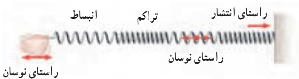
شکل ۴-۱۰- انتشار موج طولی در فنر
