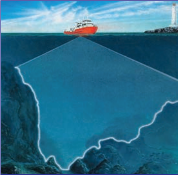
شکل ۱۰- نقشه برداری دریایی (آب‌نگاری)
