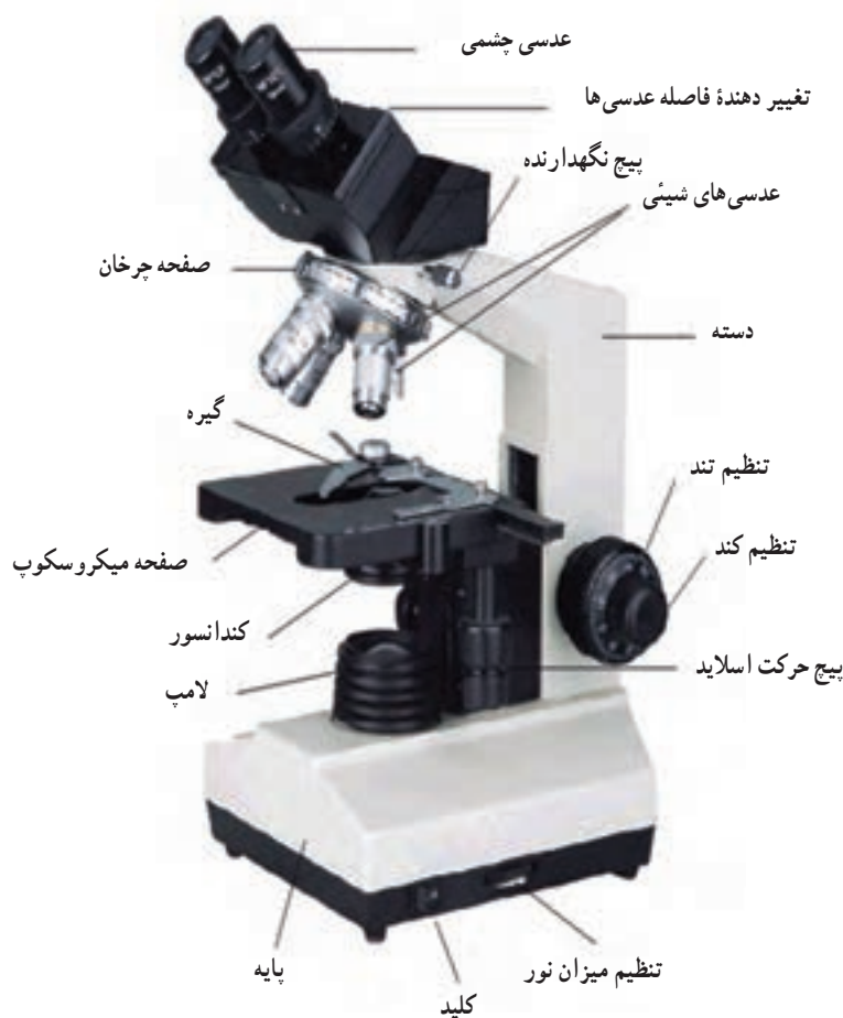
شکل ۴-۲- بخش‌های اصلی یک میکروسکوپ نوری
