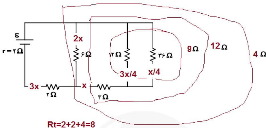
۲۲۶- در مدار زیر، جریان الکتریکی که از سیم رابط MN می‌گذرد، چند آمپر است؟
