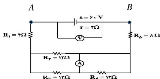
مقاومت  $R_4$  اتصال کوتاه است و از مدار حذف می‌شود. دو مقاومت  $R_3$  و  $R_2$  موازی‌اند و معادل آنها برابر با  $6 \text{ (}\Omega\text{)}$  می‌باشد.
