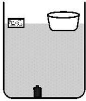
ظرف خالی و قطعه چوب روی آب شناورند، بنابراین برای هر دو نیروی شناوری  $F_b$  با وزن جسم برابر است. زمانی که قطعه چوب را داخل ظرف قرار می‌دهیم، وزن مجموعه قطعه چوب و ظرف دقیقاً برابر مجموع وزن آنها در حالت قبل است و چون این مجموعه همچنان شناور باقی می‌ماند پس نیروی شناوری  $F_b$  نیز برابر با وزن مجموعه و یکسان با حالت قبل است. طبق اصل
