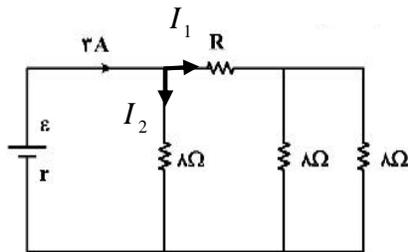
مقاومت معادل دو مقاومت ۸ اهمی سمت راست مدار برابر با ۴ اهم است. پس از آن مقاومت ۴ اهمی بدست آمده با مقاومت  $R$  نشان داده شده متوالی بوده و در نتیجه مقاومت معادل آنها برابر با  $R + 4(\Omega)$  می‌باشد. جریان عبوری از این مقاومت معادل  $I_1$  است. این مقاومت با مقاومت ۸ اهمی باقی مانده موازی است و بنابراین اختلاف دو سر آنها یکسان است. بنابراین:
