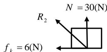
$$\tan(\theta_2) = \frac{30}{6} = 5 \text{ بنابراین: } \theta_2 \text{ زاویه بین } R_2 \text{ و } f_k \text{ می‌باشد.}$$
