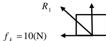
$$\tan(\theta_1) = \frac{50}{10} = 5 \text{ بنابراین: } \theta_1 \text{ زاویه بین } R_1 \text{ و } f_k \text{ می‌باشد.}$$
