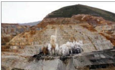
■ شکستن سنگ در معادن سنگ و تخریب ایمن سازه‌های عظیم و آسمان خراش‌ها با استفاده از دینامیت بدون آسیب رسیدن به ساختمان‌های اطراف.
