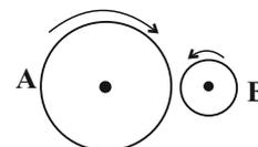
$$\frac{\text{سرعت چرخ‌دنده ورودی}}{\text{سرعت چرخ‌دنده خروجی}} = \frac{\text{تعداد دندانه‌های چرخ‌دنده خروجی}}{\text{تعداد دندانه‌های چرخ‌دنده ورودی}}$$
