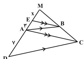
$$\Delta MCD : AB \parallel CD \xrightarrow{\text{تالس}} \frac{AB}{CD} = \frac{MB}{MC} = \frac{MA}{MD} \quad (۱)$$
