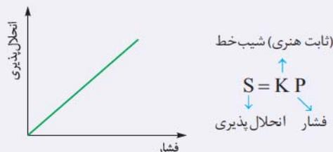
نمودار انحلال پذیری گازها بر حسب فشار به صورت خطی با شیب ثابت است؛ پس می‌توان گفت با  $n$  برابر شدن فشار، انحلال پذیری گاز هم  $n$  برابر می‌شود. معادله انحلال پذیری گازها بر حسب فشار را می‌توان به صورت روبه‌رو نشان داد:
