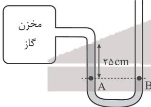
$$P_A = P_B \Rightarrow P_{\text{گاز}} + P_{\text{مایع}} = P_0 \Rightarrow \frac{P_{\text{گاز}}}{\rho_{\text{گاز}}} - P_0 = -P_{\text{مایع}}$$
