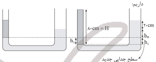
$$V_1 = V_2 \Rightarrow A_1 h_1 = A_2 h_2 \Rightarrow A_1 h_1 = 2 A_2 h_2 \Rightarrow h_1 = 2 h_2$$
