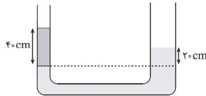
$$\rho_1 h_1 = \rho_2 h_2 \Rightarrow \rho_1 \times 40 = \rho_2 \times 20 \Rightarrow \rho_1 = 0.5 \frac{\rho_2}{\text{cm}^3}$$
