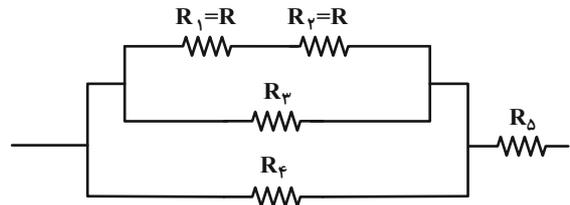
مقاومت‌های موازی  $R_3$  و  $R_4$  با مقاومت معادل  $R_1$  و  $R_2$  موازی هستند، در نتیجه اختلاف پتانسیل دو سر آن‌ها برابر است. اگر اختلاف پتانسیل دو سر مقاومت
