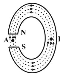
با توجه به این که خط‌های میدان مغناطیسی، منحنی‌هایی بسته هستند که در خارج از آهنربا از N به S و در داخل آهنربا از S به N می‌باشند، بنابراین جهت میدان مغناطیسی در نقاط A و B به ترتیب به صورت  $\downarrow$  و  $\uparrow$  است.
