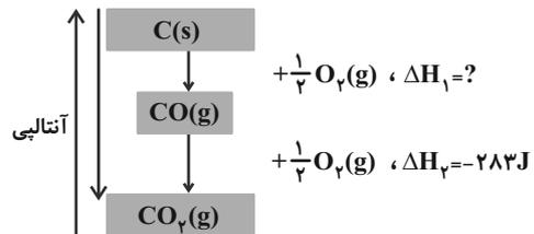
آنتالپی مرحله نخست گرافیت را نمی‌توان به روش تجربی اندازه گرفت، زیرا فرآورده آن یعنی کربن مونوکسید به سرعت با گاز اکسیژن واکنش می‌دهد. همانطور که در این نمودار مشخص است، اختلاف سطح انرژی گاز کربن مونوکسید با گاز کربن دی‌اکسید، بیشتر از اختلاف سطح انرژی گاز کربن مونوکسید با گرافیت می‌باشد، پس می‌توان نتیجه گرفت آنتالپی واکنش مرحله دوم (مرحله‌ای که می‌توان آنتالپی آن را به صورت تجربی اندازه گرفت) منفی‌تر از مرحله اول است.
