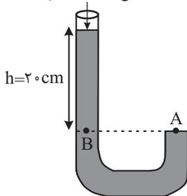
مشاهده می‌شود فشار ستون ۲۰ سانتی‌متری از مخلوط دو مایع برابر فشار ستون ۲ سانتی‌متری از جیوه است. در این حالت به صورت زیر چگالی مخلوط دو مایع را حساب می‌کنیم.
