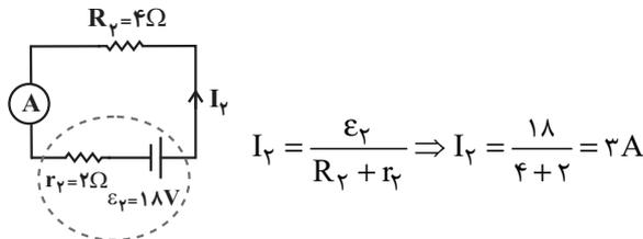
بنابراین جریان عبوری از آمپرسنج نسبت به حالت قبل  $I_2 - I_1 = 3 - 2 = 1A$  افزایش می‌یابد.
