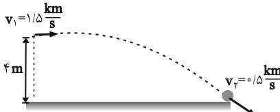
$$W_t = \Delta K \Rightarrow W_{\text{ مقاومت هوا}} + W_{\text{mg}} = K_2 - K_1$$
