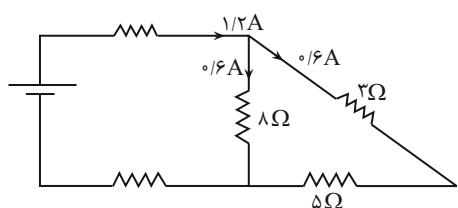
در اتصالات سری، جریان های برابرند  $\rightarrow I_{\Delta\Omega} = I_{\Lambda\Omega} = 0/6A$
