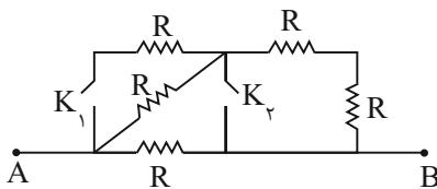
(۱) بیشترین مقاومت معادل در مدار زمانی است که کلید  $K_1$  بسته و کلید  $K_2$  باز باشد.
