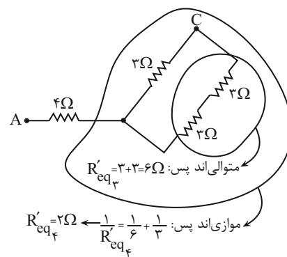
بنابراین شکل ساده شده مدار به این صورت است و مقاومت معادل بین نقاط C و A، با توجه به سری (متواالی) بودن مقاومت‌های 4Ω و 2Ω برابر است با:
