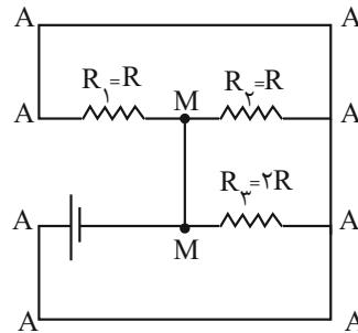
چون مقاومت  $R_3$ ، ۲ برابر مقاومت  $R_1$  و  $R_2$  است، پس جریان گذرنده از  $R_3$  و  $R_2$ ، ۲ برابر جریان  $R_1$  است.
