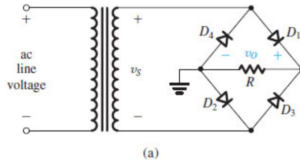
**Figure 4.23 (a)** The bridge rectifier: circuit.
