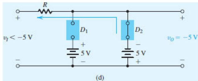
Figure 4.6 (d) The equivalent circuit when  $v_I < -5$  V.
