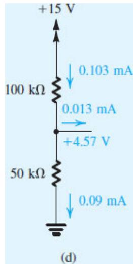
Figure 6.29 (d) Circuit for Example 6.10.
