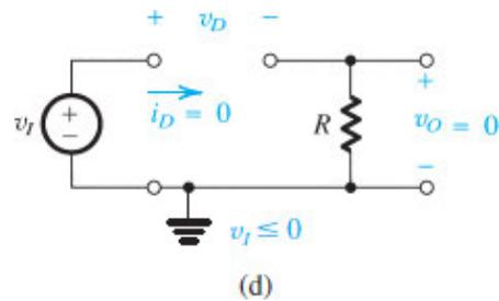
**Figure 4.3 (d)** Equivalent circuit when  $v_I \leq 0$ .
