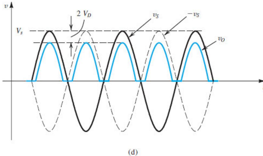
**Figure 4.23 (d)** The bridge rectifier: input and output waveforms.
