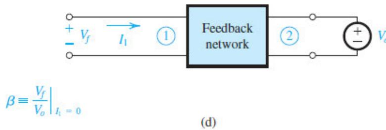
Figure 11.16 (d) Determination of the feedback factor  $\beta$ .
