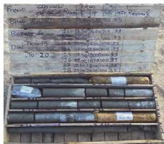
حفاری گمانه اکتشافی توسط دستگاه حفاری مغزه‌گیری توسط گمانه‌های اکتشافی
