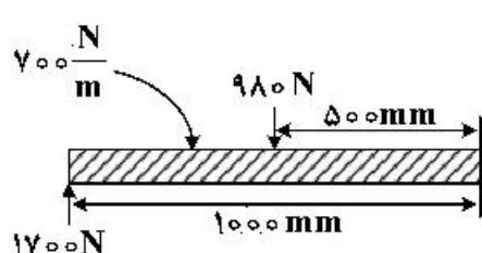
۱۱۲- ممان خمشی  $\max$  در شکل زیر، چند نیوتن متر است؟
