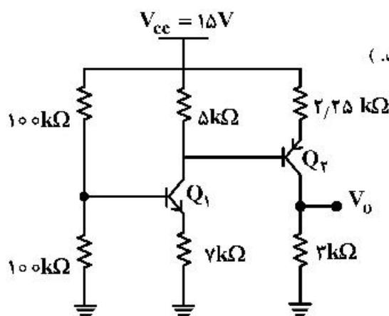
۱۱۸ در مدار زیر، مقدار V<sub>o</sub> چند ولت است؟
