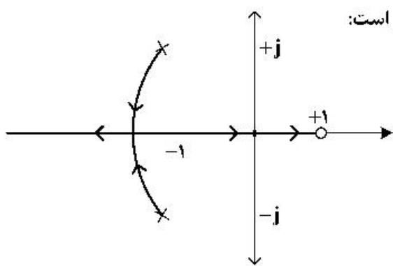
مکان به ازای بهره  $K \geq 0$  رسم شده است. به ازای  $K = -2$ ، وضعیت سیستم چگونه است؟
