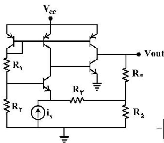
۱۵۲- در مدار زیر، مقدار تقریبی بهره  $A = \frac{V_{out}}{i_s}$ ، کدام است؟
