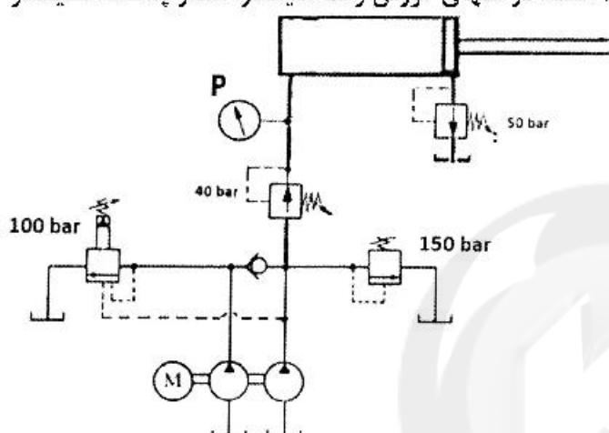
۱۲۸- در مدار زیر، در انتهای کورس رفت سیلندر، توان مصرفی یکپنجم چند کیلووات است؟
