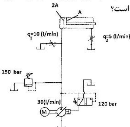
۱۳۰- در مدار زیر، سرعت سیلندر در مسیر رفت،  $\frac{m}{min}$  است. مساحت‌های دو طرف پیستون نیز داده شده است.
