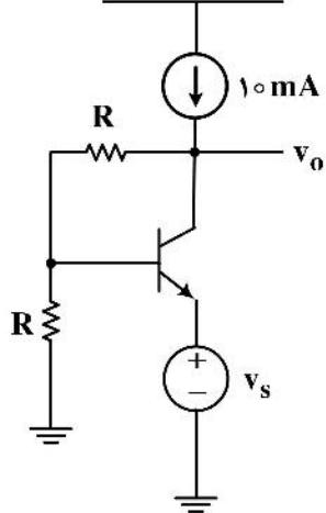
۱۲۸- در مدار شکل مقابل نسبت  $\frac{V_o}{V_i}$  به کدام گزینه نزدیک‌تر است؟
