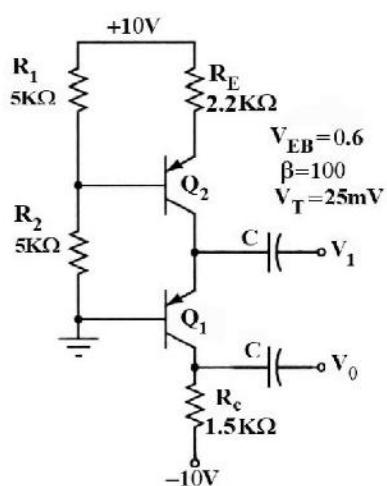
۱۲۴- در مدار شکل زیر با فرض یکسان بودن جریان بایاس ترانزیستورها و  $R = 5k\Omega$ ، بهره ولتاژ  $A_V = V_{out}/V_{in}$  کدام است؟
