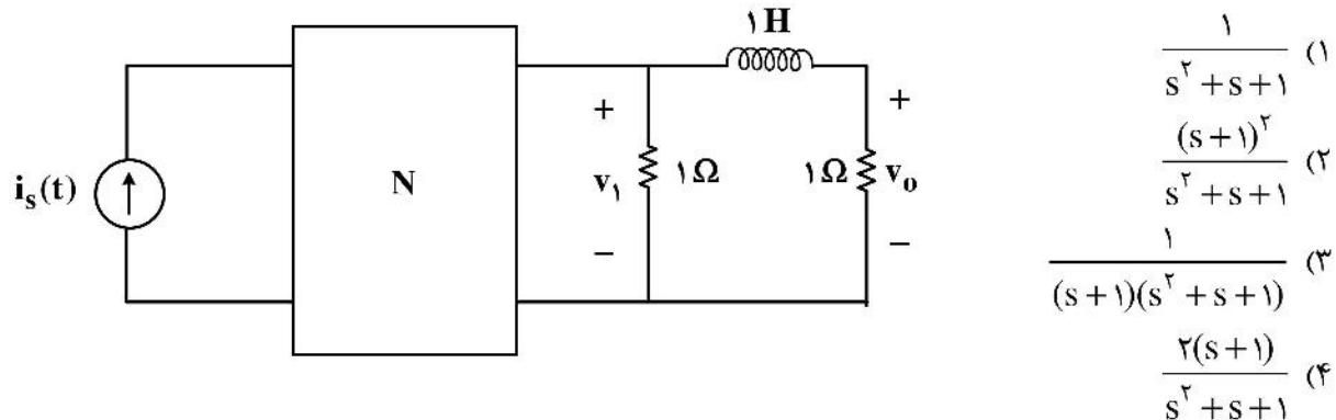
۱۱۴ - در مدار داده شده چند فرکانس طبیعی غیر صفر وجود دارد؟ (همه عناصر پسیو هستند).
