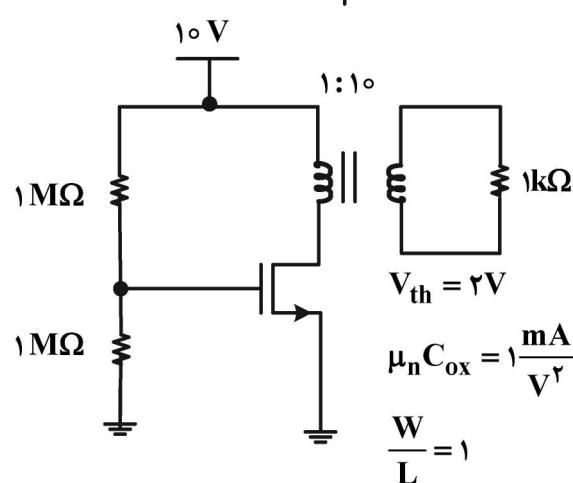
۱۴۷ - نقطه کار DC ماسفت در مدار زیر کدام است؟
