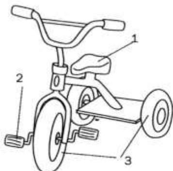
(۱) تزریق پلاستیک و پلی پروپیلن ۲- تزریق پلاستیک و پلی پروپیلن ۳- بادی و پلی اتیلن
