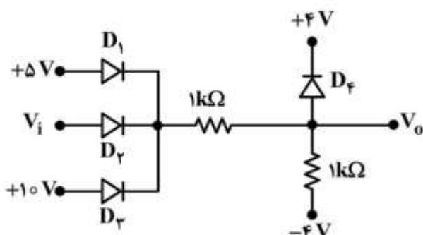
۱۱۷- در مدار زیر، همه دیودها با هم یکسان بوده و دارای ولتاژ آستانه هدایت  $V_{D,ON} = 0.7V$  هستند. کدام دیود
