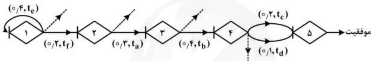
$$t_f + \frac{1}{3}t_e + (t_a + t_b) + \text{Max}\{t_c, t_d\} \quad 7 \times 10^{-3} \quad (1)$$
