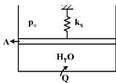
$$(V_2 - V_1) \left[ \left( \frac{p_1 + p_2}{2} \right) + p_0 \right] \quad (1)$$
