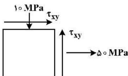
۶۳- شکل زیر میله‌ای را تحت پیچش نشان می‌دهد. اگر تنش برشی روی جزء a برابر  $10 \text{ MPa}$  باشد، بزرگی تنش عمودی روی جزء c، چند مگاپاسکال است؟
