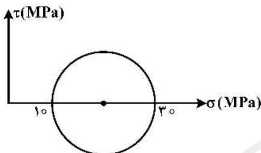
۱۳۸ - معادلهٔ معیار شکست سنگی  $\sigma_1 = 10 + 35\sqrt{3}$  است. زاویهٔ اصطکاک داخلی سنگ چند درجه است؟
