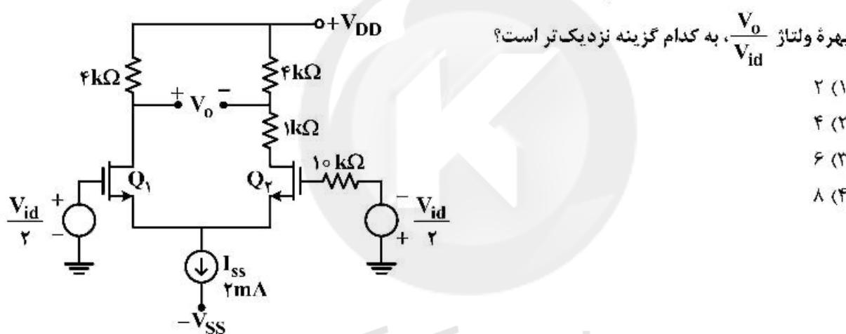
بهره ولتاژ  $\frac{V_o}{V_{id}}$ , به کدام گزینه نزدیک‌تر است؟
