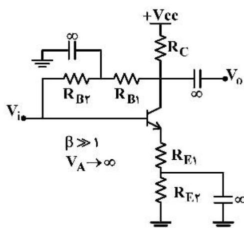
۱۲۲ - بهره ولتاژ تقویت‌گننده زیر به کدام گزینه نزدیک‌تر است؟
